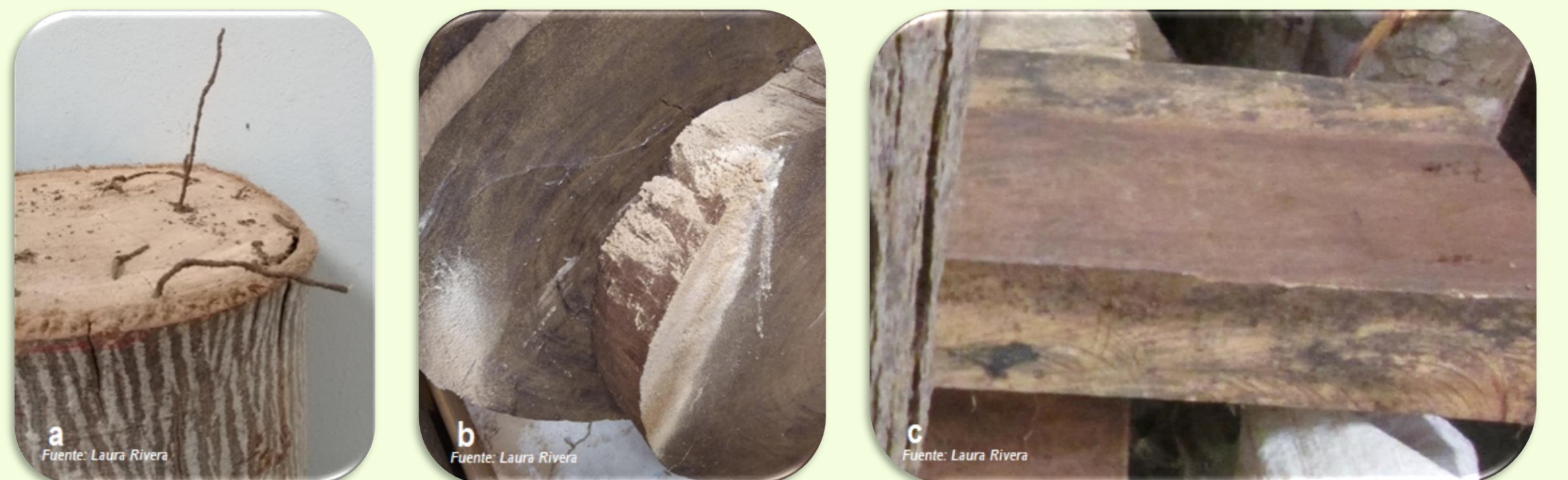
Galerías de termitas subterráneas en una troza de Ceiba aesculifolia (a), rodajas y parte de un tablón de Enterolobium cyclocarpum con polvillo generado por la afectación de coleópteros xilófagos (b) y hongos cromógenos (c).
